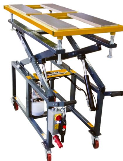
La portata massima di questo modello è di 1600 Kg e le dimensioni insieme alla sua struttura ad “H” lo rendono un prodotto unico sul mercato, il quale permette il massimo spazio di manovra e il passaggio sotto ogni tipo di ponte sollevatore.
